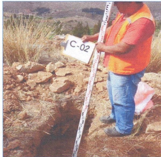
Foto N° 01: En la toma se observa toma de estrato a 30cm en la calicata C-02
