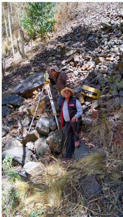
Fotografía 6: Levantamiento topográfico de Línea de Conducción
