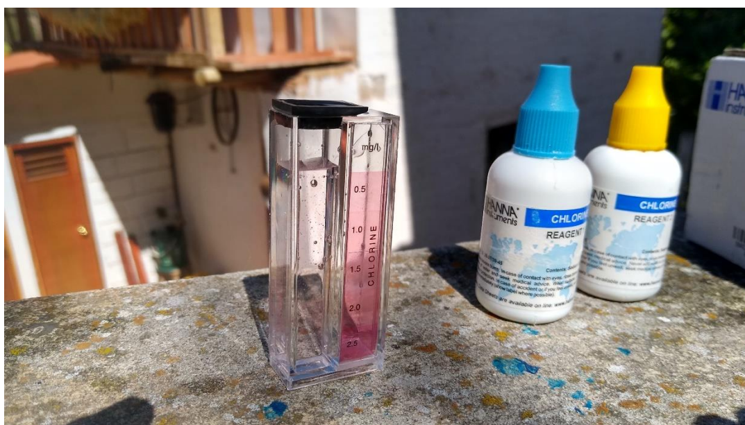
Fotografía 22: Kit de test de cloro residual utilizado para la evaluación de calidad del agua potable
