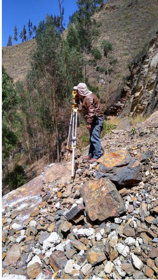
Fotografía 15: Levantamiento topográfico de la línea de conducción
