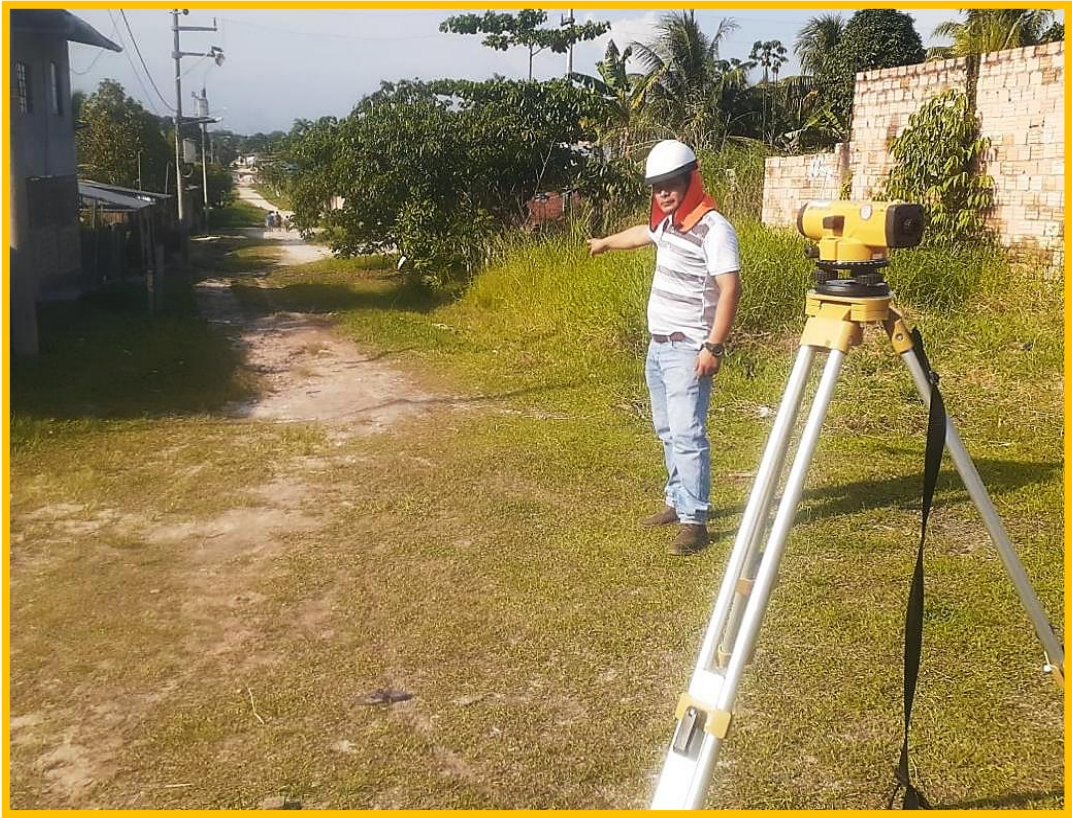
Imagen 3. Aplicación del levantamiento tografico en la línea de aducción de la localidad de Pache, distrito de Cochabamba, provincia de Huaraz, Departamento Áncash.
