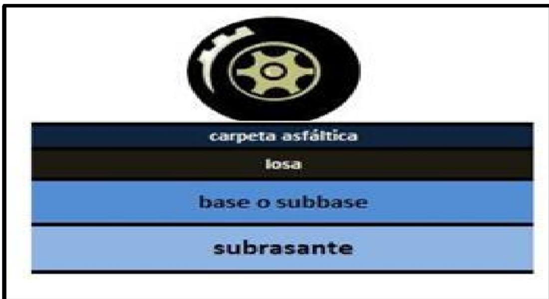
Figura 2.3: Estructura típica del pavimento híbrido.
