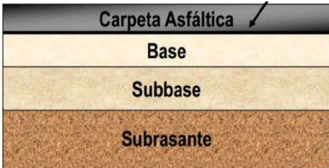
Figura 2.1: Estructura de un pavimento flexible.
