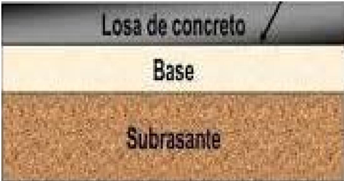
Figura 2.2: Pavimento Hidráulico.
