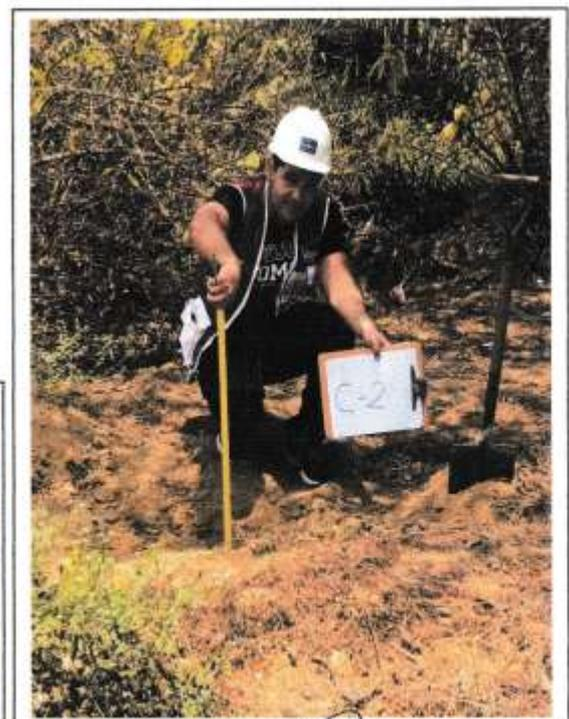
**Foto N°02:** Vista de la C-02, presencia de suelo natural con materia orgánica en su parte superficial y raíces hasta 0.20m.; seguido de Grava Limo-Arcillosa con Arena (GM-GC), con finos plásticos, densidad natural medianamente compacto, ligeramente húmedo a húmedo y de color marrón oscuro. Excavación realizada en zona del Reservoirio.
