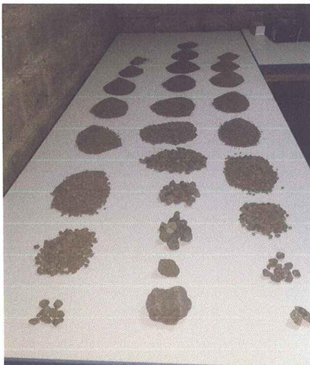
Foto N° 11.- Se aprecia el tamizado de muestra con las partículas obtenidas de cada uno de los tamices, para las muestras extraídas
