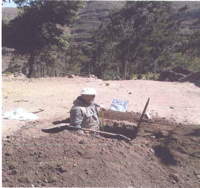
Foto N° 05.- Se aprecia en detalle la profundidad de la calicata C-05 y en la parte superficial material orgánico.
