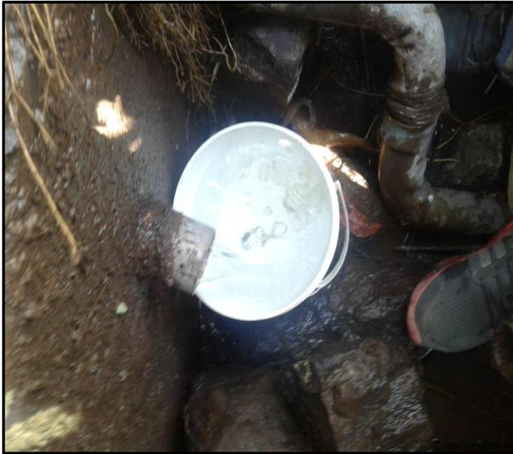
**Descripción:** En la imagen se puede apreciar la medición del caudal de la fuente para luego realizar el cálculo volumétrico q determinará el caudal total de la fuente q abastece al caserío de Vista Alegre.
