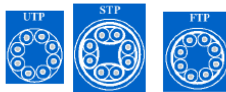
Gráfico Nro. 2: Tipos de Par trenzado
