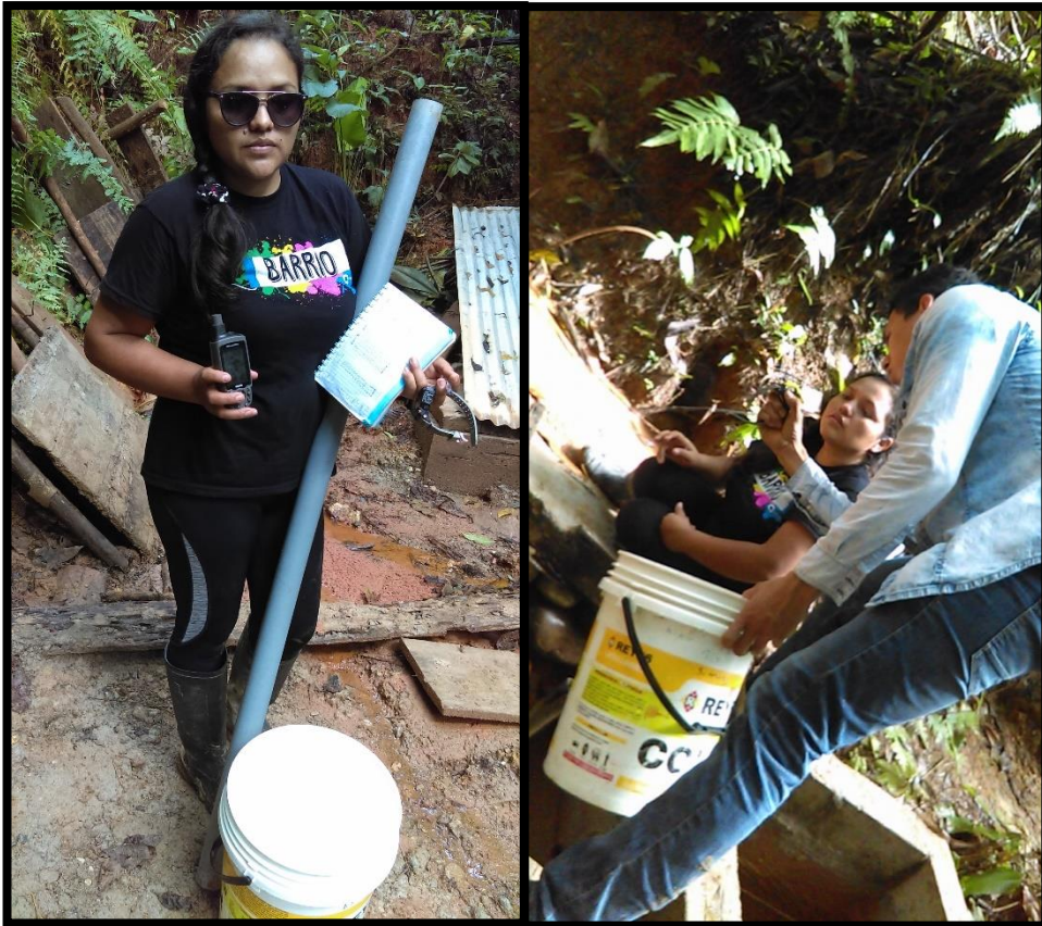
Figura 26: Aforo de la fuente por el método volumétrico, con los materiales necesarios. Fuente: Elaboración propia
