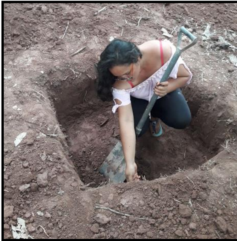
Figura 31: Elaboración de la calicata a 30 cm de profundidad Fuente: Elaboración propia
