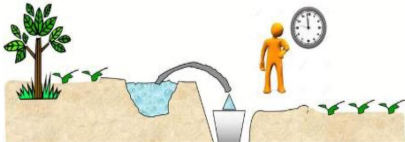
**Figura 9.** Medición del caudal por el método volumétrico
