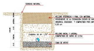
SECCION TIPICA - LINEA DE ADUCCION
