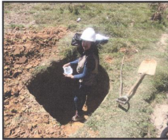
Foto N° 05.- En la toma se aprecia la excavación de la calicata C-05
