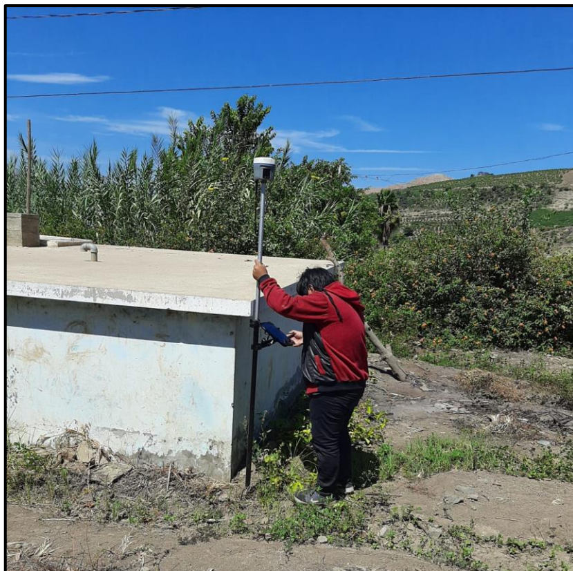
Fotografía 07: Tomando coordenadas en el reservorio existente.
