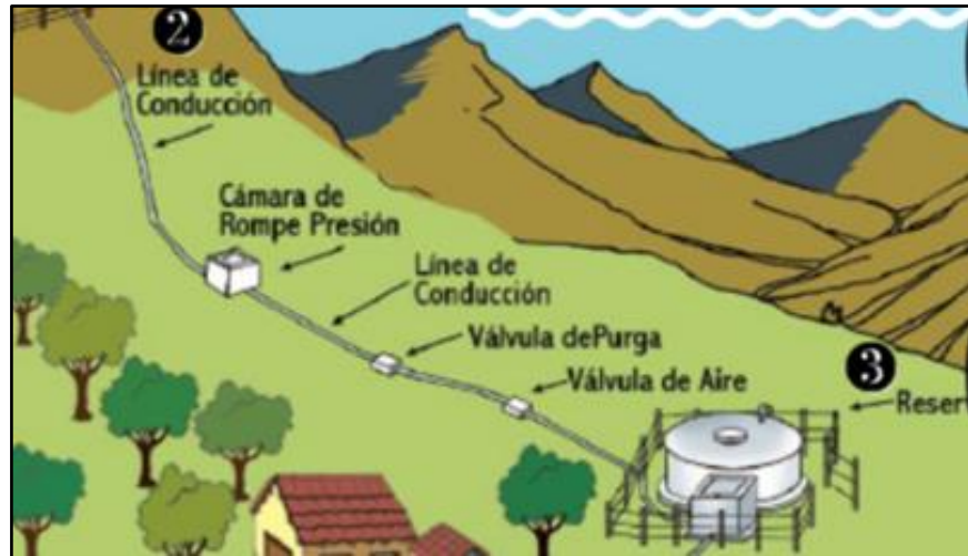
Figura 11: Línea de conducción
