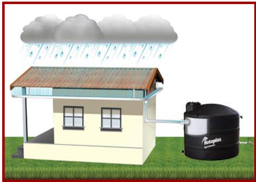
Figura 2. Captación de agua pluvial en vivienda.
