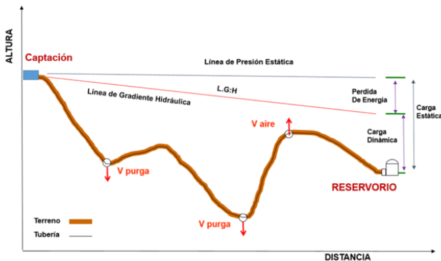
ILUSTRACIÓN N° 1 LÍNEA DE CONDUCCIÓN
