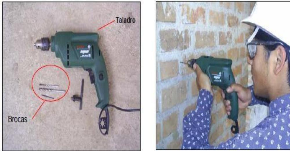
**Fig. 5.08:** Herramientas utilizadas en las Perforaciones y Perforaciones con el taladro (Mosqueira ,Tarque .2005).
