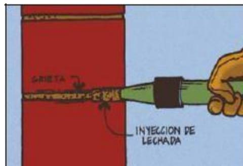
**Fig. 5.13** Inyección de grietas con lechada de mortero (AIS 2002)
