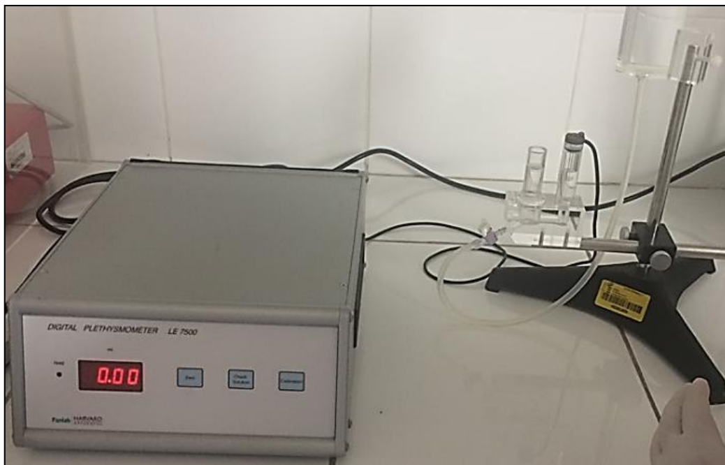
Pletismometro digital utilizado en la investigación (PANLAB -LE 7500)
