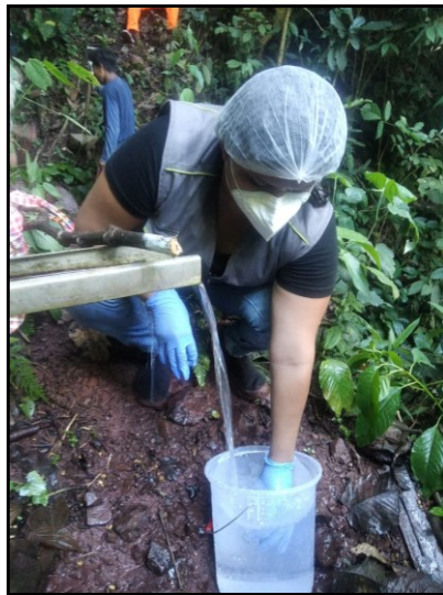
Figura 24: Aforamiento de la captacion a proyectarse
