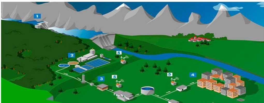
GRAFICO 2 SISTEMA DE ABASTECIMIENTO DE AGUA POTABLE
