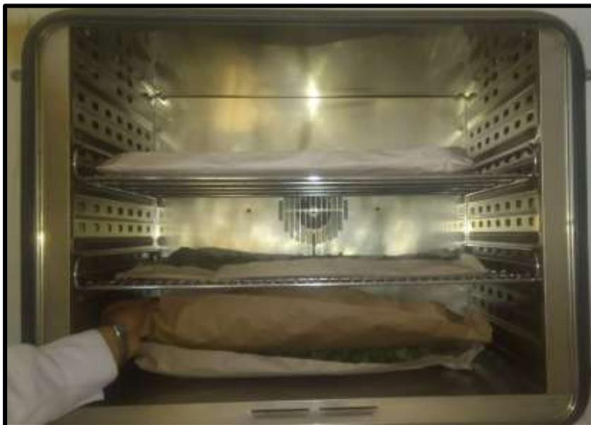
**Imagen 2:** Secar la muestra para proceder a secar en estufa a 55°C por 2 días.
