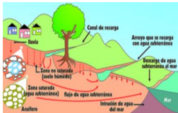
Figura 1. Flujo de aguas subterráneas
