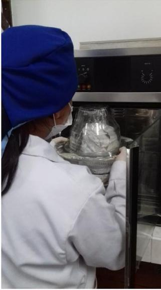
Figura 7. Incubación de las placas Petri en la jarra Gaspar mediante el método de la vela.
