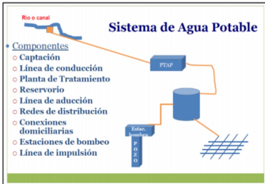
**Figura 03:** Sistema de agua potable
