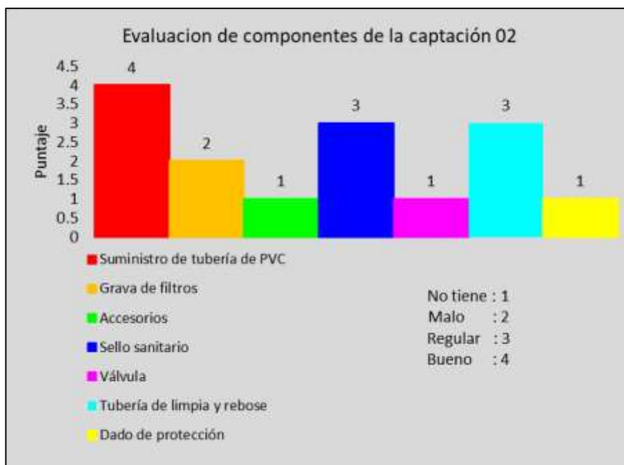
Gráfico 4. Estado de los componentes de la captación 02
