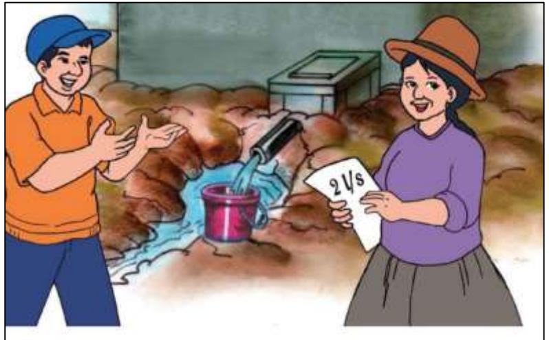
Imagen 5 Medición del caudal por el método volumétrico
