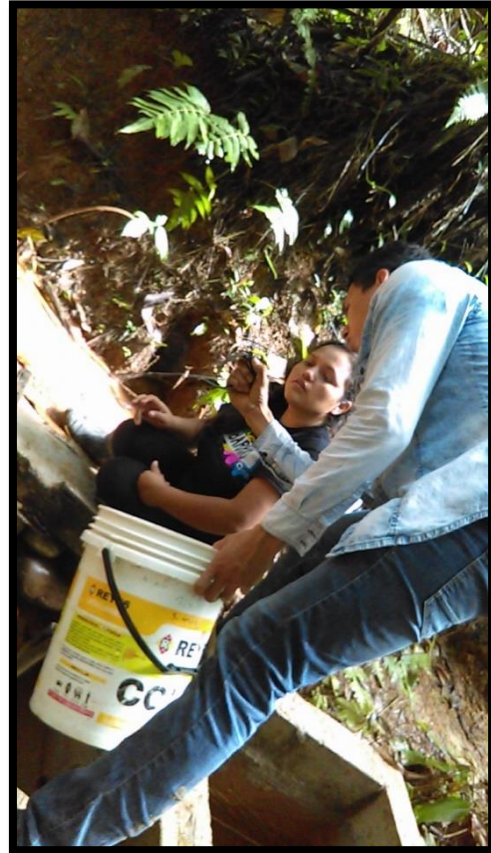
Figura 26: Aforo de la fuente por el método volumétrico, con los materiales necesarios.
