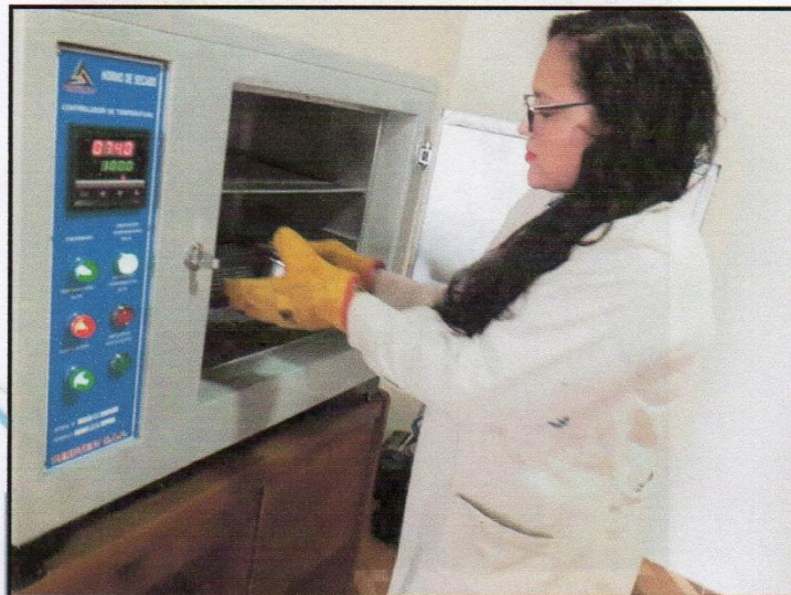
Fotografía N° 07: SECADO DE MUESTRA EN EL HORNO
