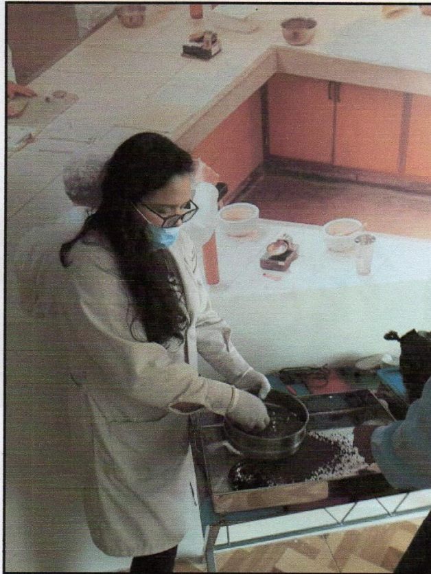
Fotografía N° 07: SECADO DE MUESTRA EN EL HORNO
