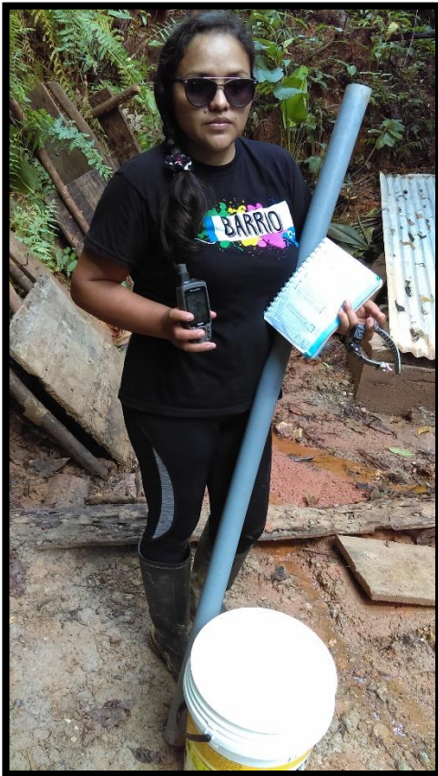
Figura 26: Aforo de la fuente por el método volumétrico, con los materiales necesarios.
