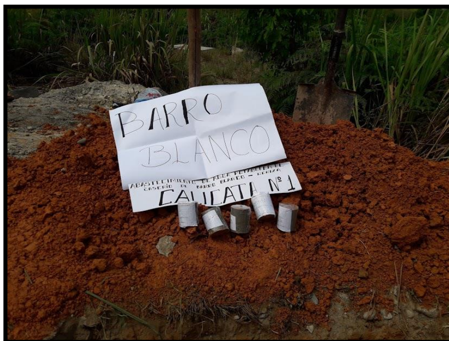
Figura 32: Recolección de muestras de suelo por estratos de calicata.
