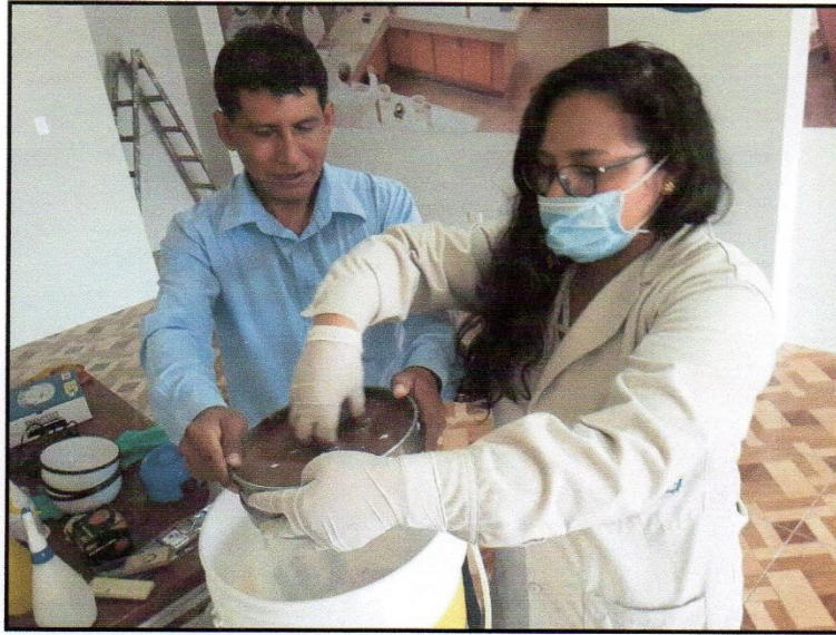
Fotografía N° 08: LAVADO DE MUESTRA PARA ANALISIS GRANULOMETRICO
