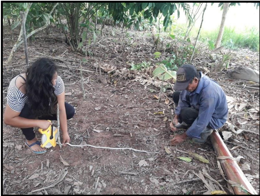
Figura 30: Trazo para la elaboración de calicatas.
