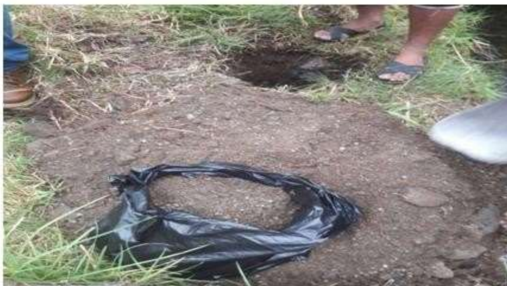
Muestras de suelo extraídas de las calicatas para su estudio.
