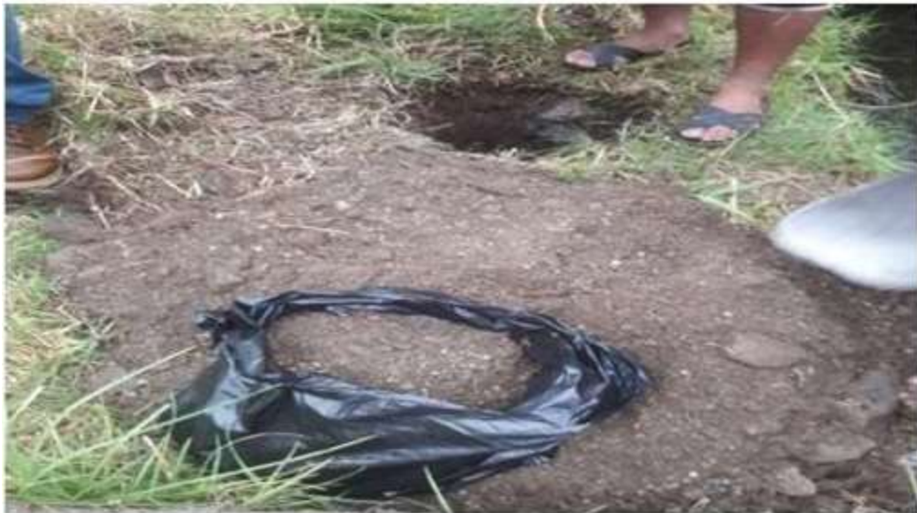
Imagen N°04: se puede apreciar las muestras extraídas de las calicatas en línea de conducción para el estudio de mecánica de suelos.
