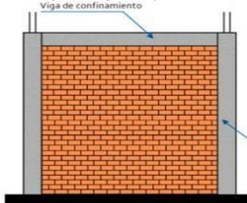
Imagen 08: Viga de confinamiento
