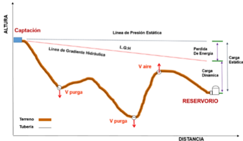
Ilustración N° 03.31. Línea de Conducción
