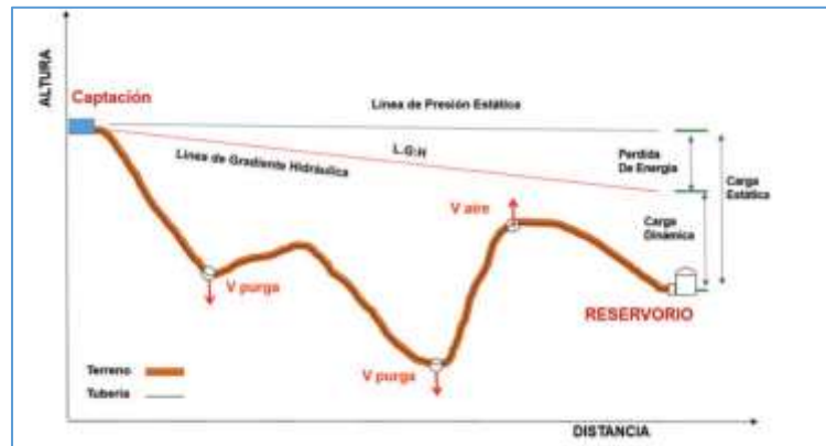
imagen 10 Línea de conducción por gravedad
