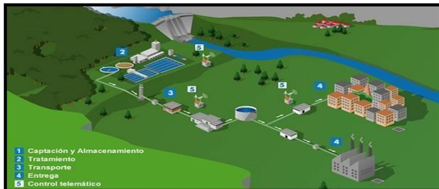
**Figura 6.** Sistema de abastecimiento de agua potable
