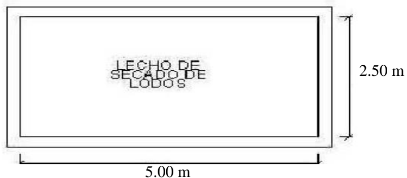
Figura 30. Planta de Lecho de Secado de Lodos.
