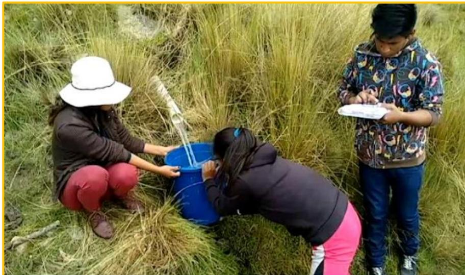
**Imagen 02:** Aforo de agua método volumétrico
