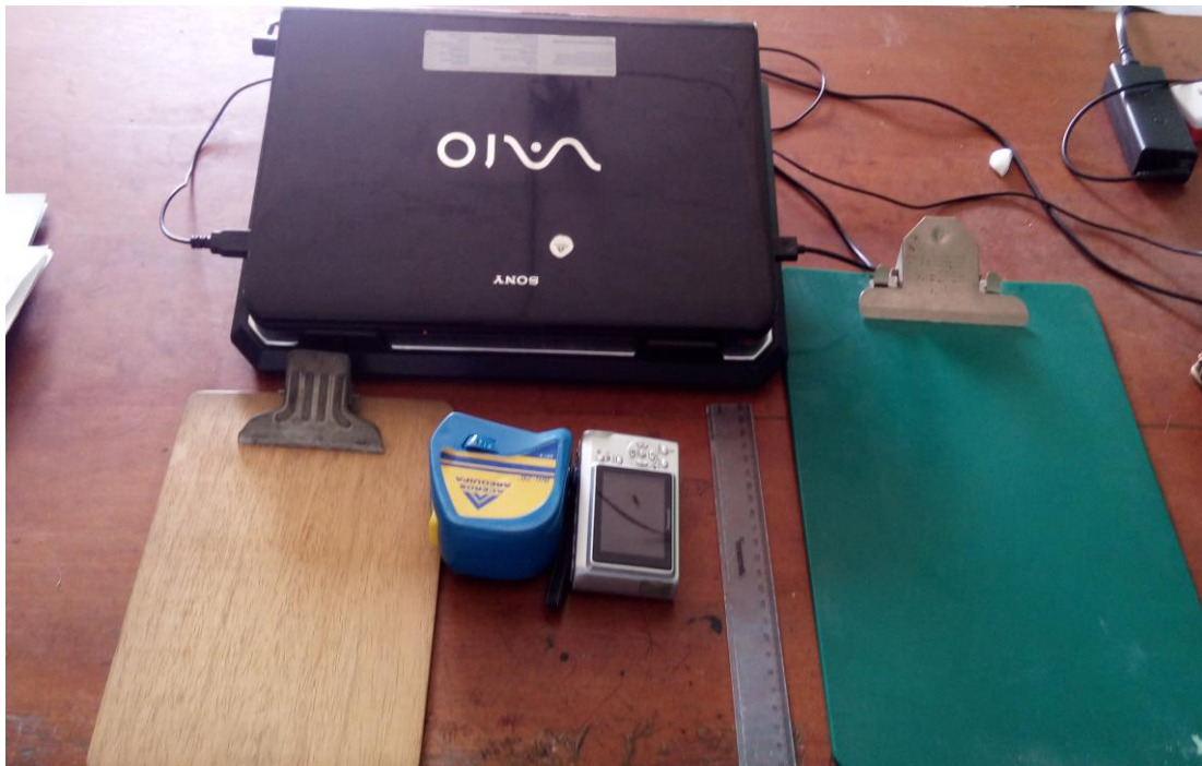
Figura 117: Instrumentos para evaluar el Índice condición de pavimento. (Laptop, tablillas, metro, regla, cámara fotográfica)
