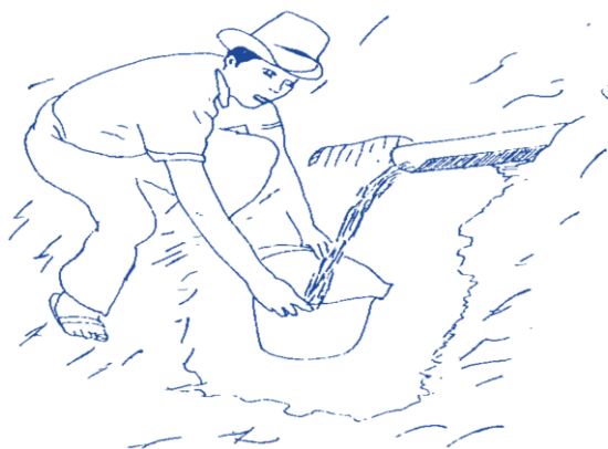
FIGURA N° 10 “Aforo del agua por el método volumétrico”
