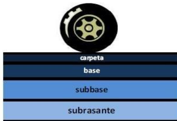
Gráfico 1: Esquema típico del paquete estructural de un pavimento flexible.
