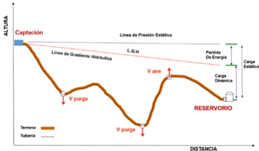
Ilustración N° 03.31. Línea de Conducción
