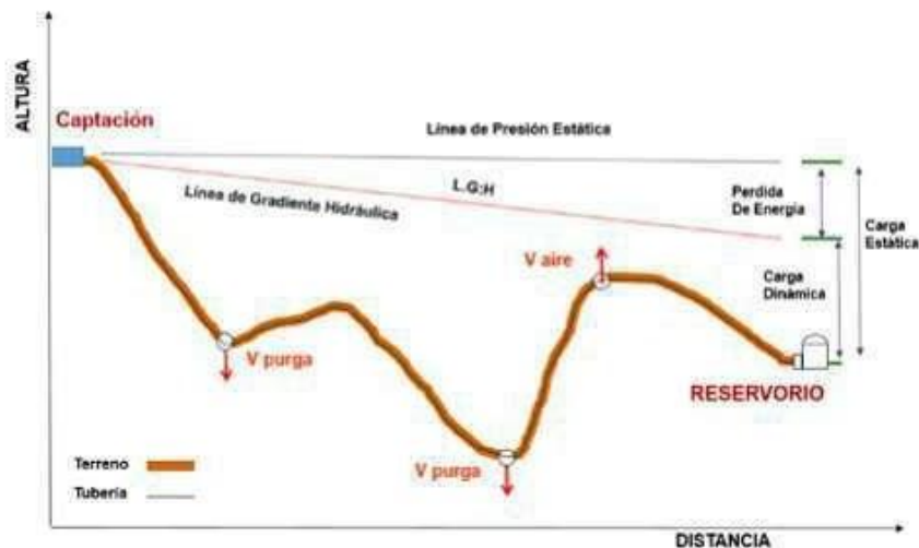
Ilustración N° 03.31. Línea de Conducción
