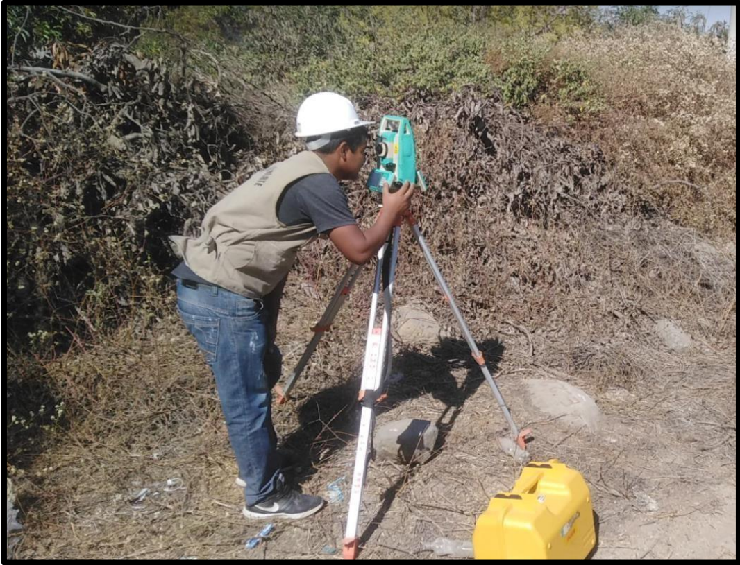
Imagen n° 02: Levantamiento topográfico de la línea de conducción
