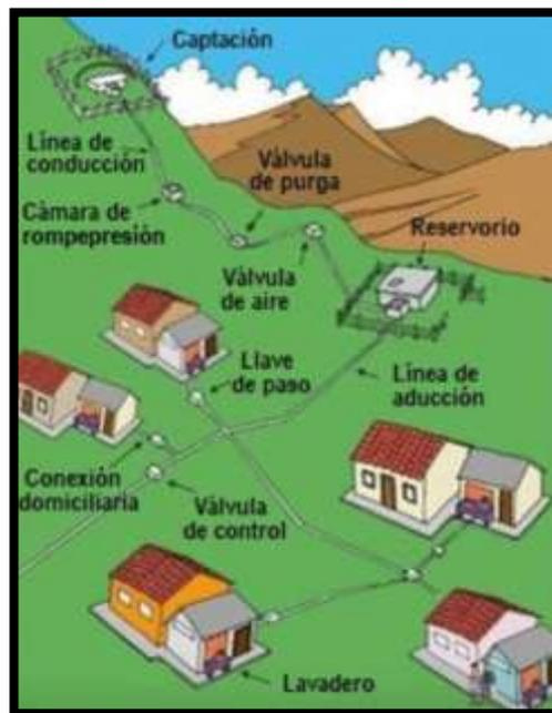
**Figura 6.** Sistema de abastecimiento de agua potable.
