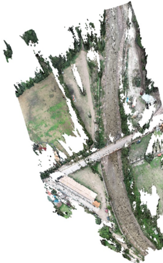
Figura 5.18: Modelo de nube de puntos denso. Fuente: Elaboración propia.
