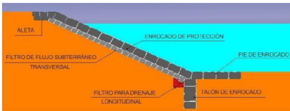
Figura 2.5: Partes del enrocado.
