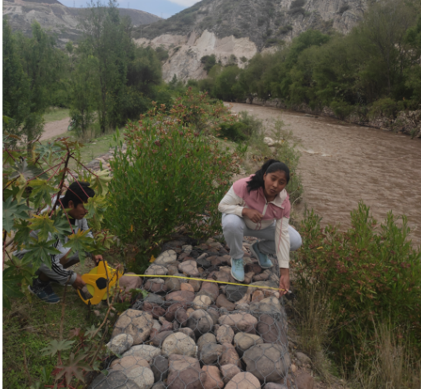
Figura 5.3: Medición del ancho de gavión.
