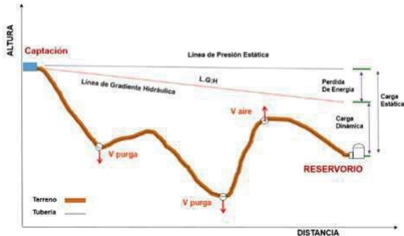
Ilustración N° 03.31. Línea de Conducción
