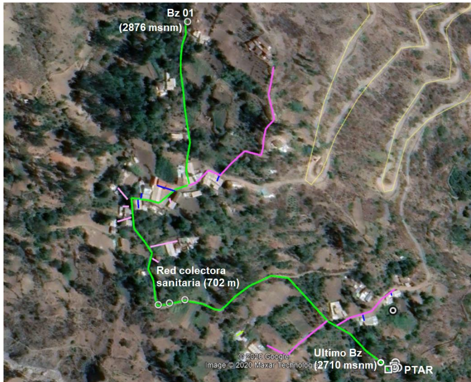
Imagen 13. Red colectora de aguas servidas, desde el primer buzón hasta el último buzón
