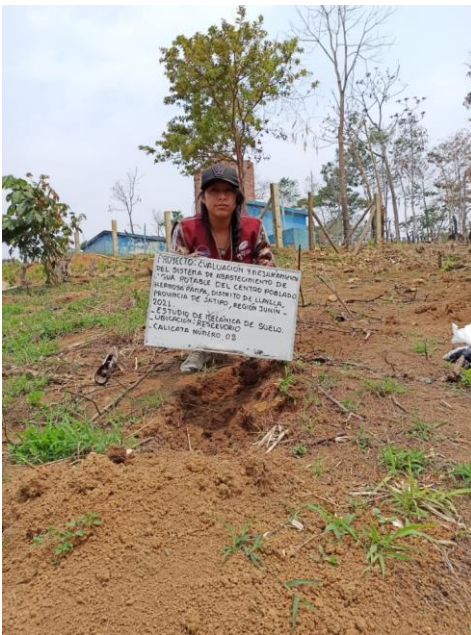
Tomando la muestra de las calicatas para el estudio de mecánica de suelos.
