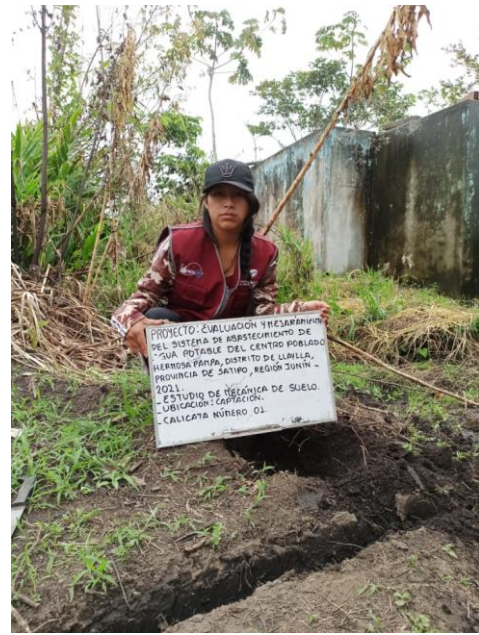
Tomando la muestra de las calicatas para el estudio de mecánica de suelos.
