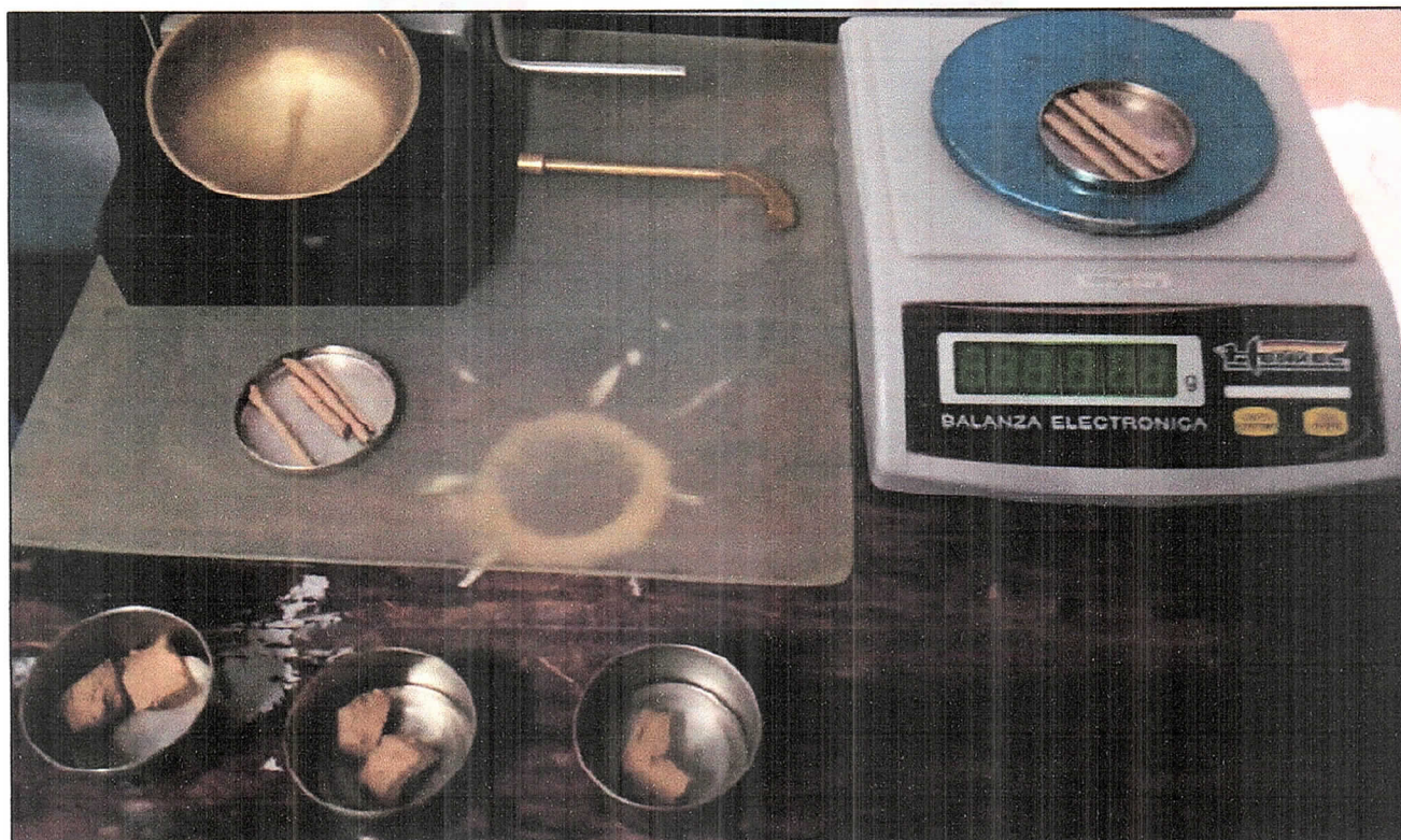
ENSAYO DE LIMITE PLASTICO DE LA CALICATA 1 UBICADO EN EL CENTRO POBLADO HERMOSA PAMPA DE LA CAPTACION EN EL LADO DERECHO
