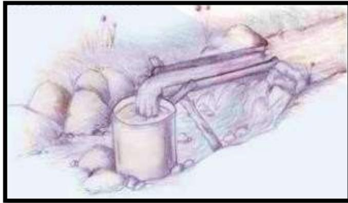
*Imagen 9 Medición del caudal por el método volumétrico*
