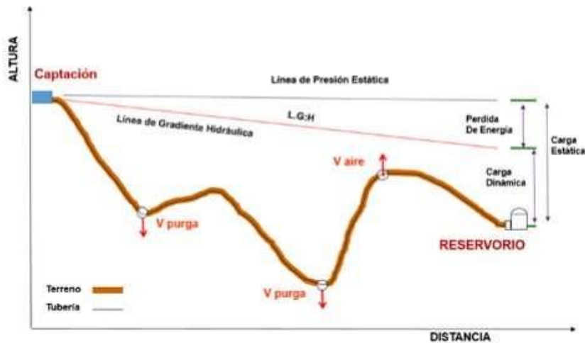
Ilustración N° 03.31. Línea de Conducción
