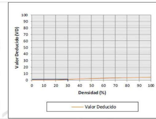
Figura 53. Valores deducidos para grietas de retracción.
