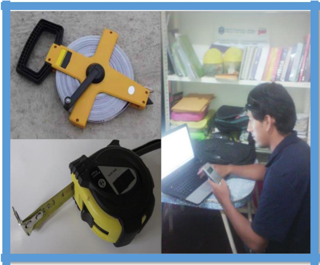
Figura 74. En esta imagen se puede observar una wincha de 100 metros, un flexómetro, una laptop, una calculadora y algunos libros estos son los instrumentos utilizados para la recolección y procesamiento de los datos.
