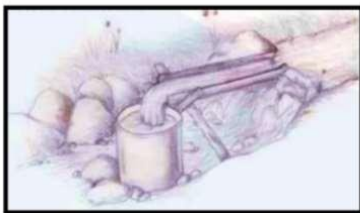
Imagen 4 Medición del caudal por el método volumétrico
