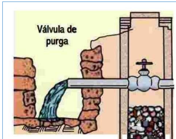
Imagen 13 Válvula de purga.
