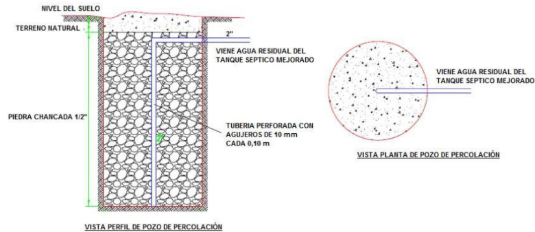
Ilustración N° 04.12. Pozo de Absorción
