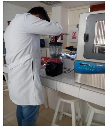
ANEXO 3: Trituración de la especie vegetal en un molino de cuchillas
