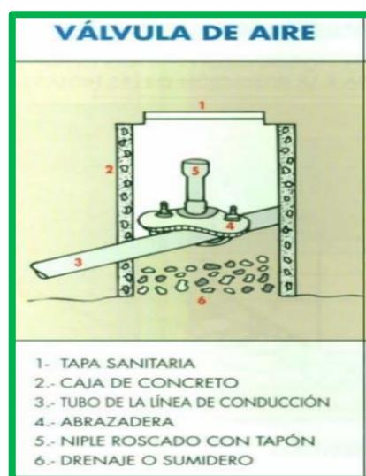
**Figura 12.** Válvula de aire.
